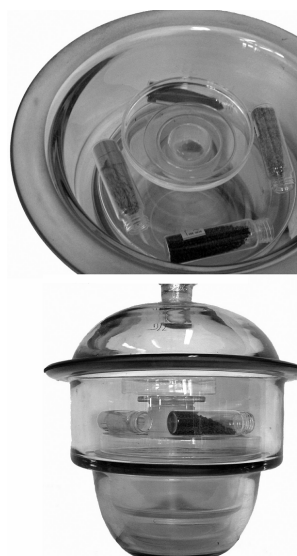
Obr. 1. Modifikovaný exikátor pro kontaminaci zemin pomocí par
