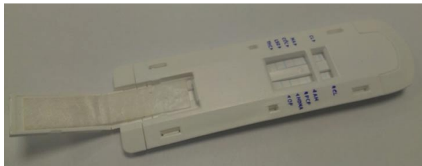
Obr. 2. Jednokrokový LFIA test pro detekci 8 druhů psychotropních látek ze vzorku slin
