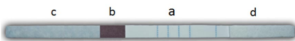
Obr. 1. Sestavený LFIA proužek: a – membrána se 4 testovacími liniemi a kontrolní linií, b – konjugační zóna, c – podložka pro nanášení vzorku, d – absorpční podložka
