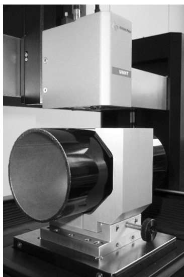
Obr. 2. Indentační zkouška na válcových vzorcích prováděná pomocí UNHT zařízení (válcový vzorek umístěn ve speciálním stojanu)
