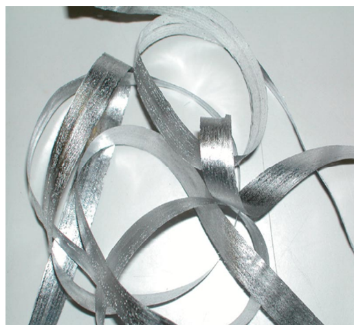
Obr. 9. Pásek rychle ztuhlé slitiny AlNi20
