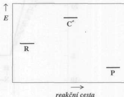
Obr. 1. Reakční profil reakce mezi molekulami (reaktanty R) vedoucí k produktům P přes Eyringův aktivovaný komplex C^\ddagger
