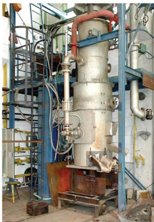
Obr. 5. Schéma reaktora MEPHREC a šachtovej pece z pilotnej skúšky v Freibergu 37
