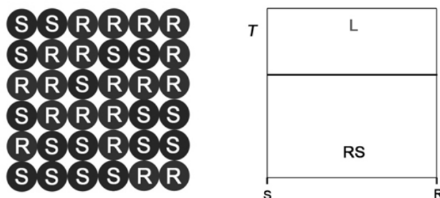
Obr. 2. Nepřavidelné uspořádání enantiomerů v krystalu a binární fázový diagram látky tvořící pevný roztok neboli pseudoracemát. Teplota tání je konstantní a nezáleží na poměru jednotlivých enantiomerů
