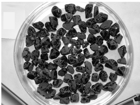
Obr. 1. Vzorka č. 5 po skúške afinity bitúmenu ku kamenivu
